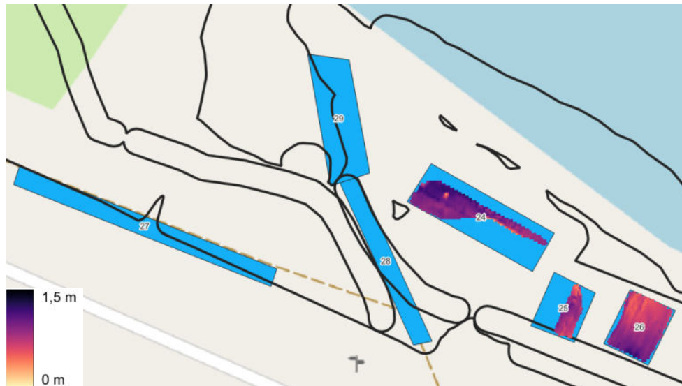
Abbildung 27 Höhenprofil der vermuteten Unterkant der Aufschüttung.
